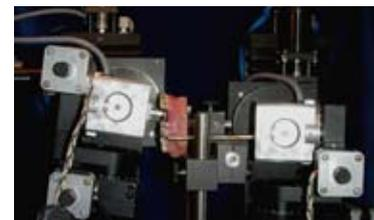
Die Messungen wurden am Orthodontischen Mess- und Simulations-System (OMSS) durchgeführt. Diese Apparatur erlaubt sowohl Absolutmessungen von Kräften in mesiodistaler, orovestibulärer und vertikaler Richtung als auch Drehmomente um diese drei Achsen. Für besondere Fragestellungen der kieferorthopädischen Biomechanik kann auch jedwede Zahnbewegung simuliert werden.
